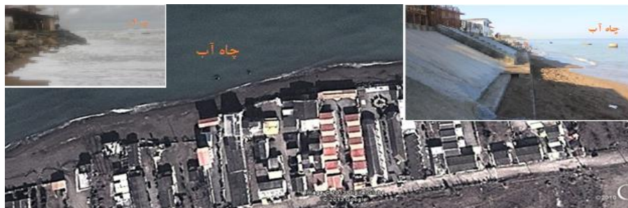
شکل ۱۴: پیشروی دریا، تغییر خط ساحلی و وجود چاه در داخل دریا ساحل بابلسر عکس میدانی و Google Earth (یوسفی روشن، کردوانی، ۱۳۹۲: ۷).
